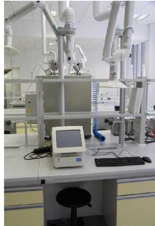
Rudolph Analytical DDM 2910 Gęstościomierz służący do pomiaru gęstości ciężaru właściwego, stężenia cieczy i gazów
