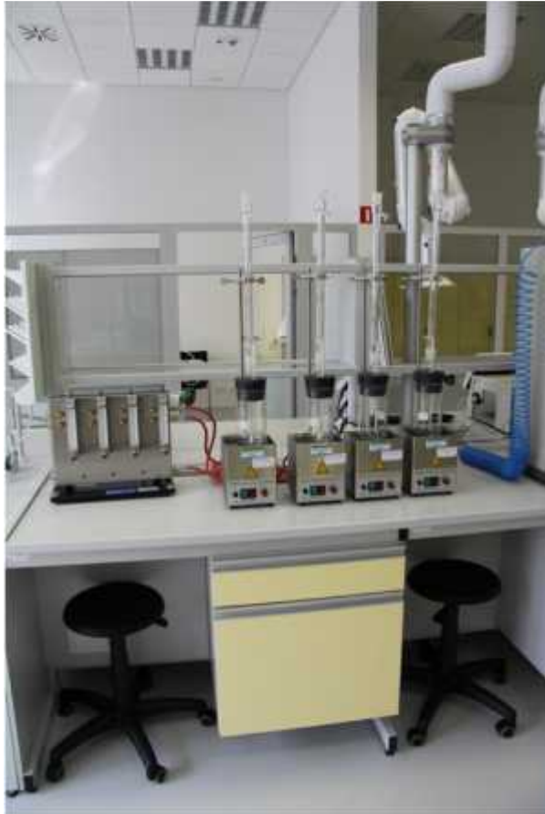
Petrotest 16-0847 Czterostanowiskowy przyrząd do pomiaru zawartości wody.
