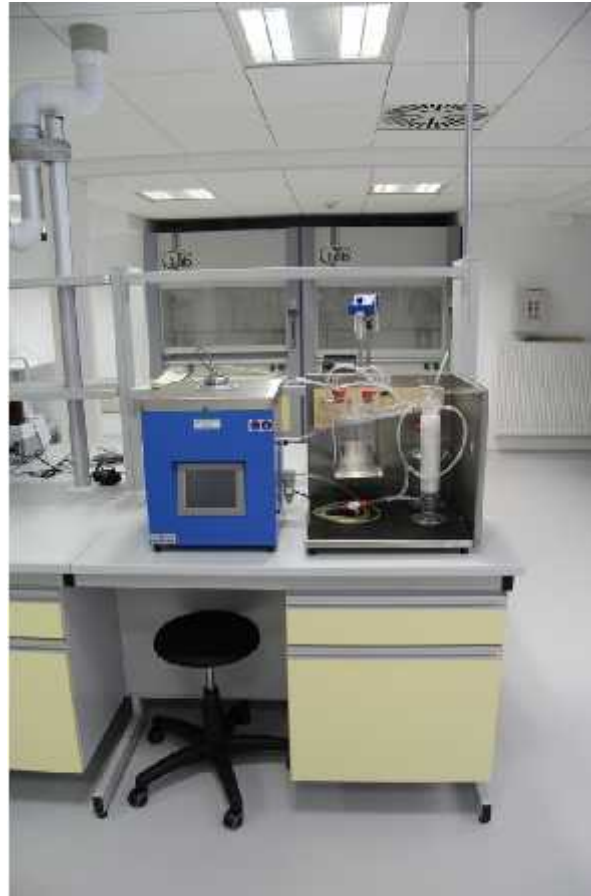
Linetronic Technologies OilLab 580. Aparat do oznaczania testu Noacka służący do odparowalności środków smarowych metodą Noack zgodnie z normą ASTM D5800
