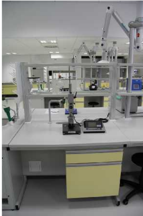
Bareiss IRHD digi test II Twardościomierz do gumy w skali twardości IRHD - urządzenie inspekcyjno-pomiarowe.
