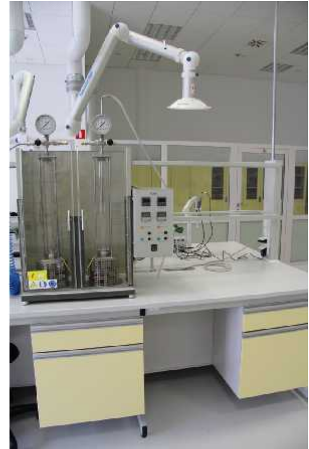
Zematra Ad 4340-110. Aparat do badania korozji zgodnie z normą ASTM D 4340
