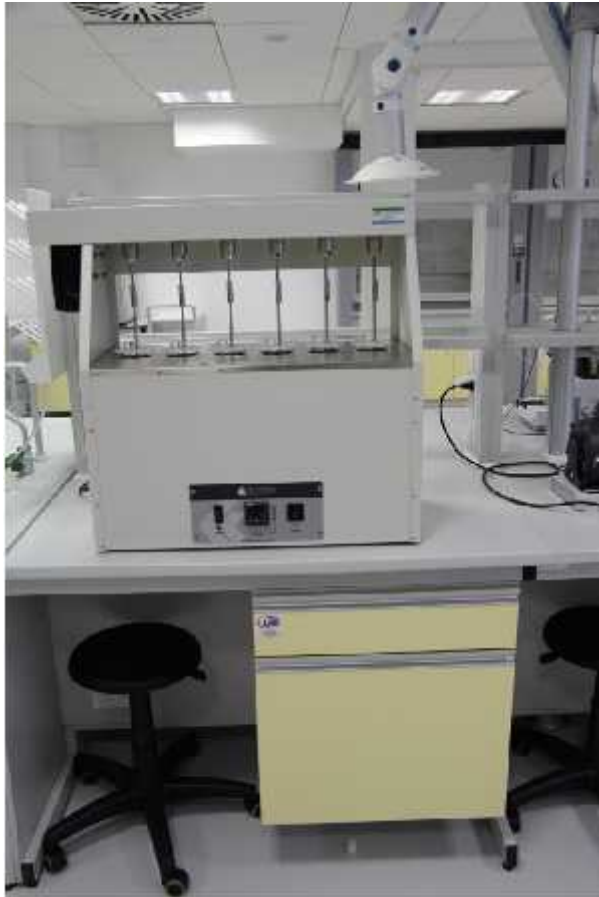
Koeher Instrument K301165 Łaźnia olejowa do oznaczania właściwości korozyjnych na trzpieniu
