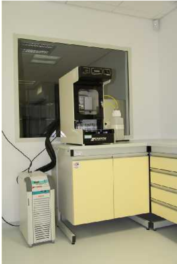
Cannon CCS 2100 służący do oznaczania lepkości olejów silnikowych w warunkach rozruchu na zimno/zakres temp. od -5 do -35 C
