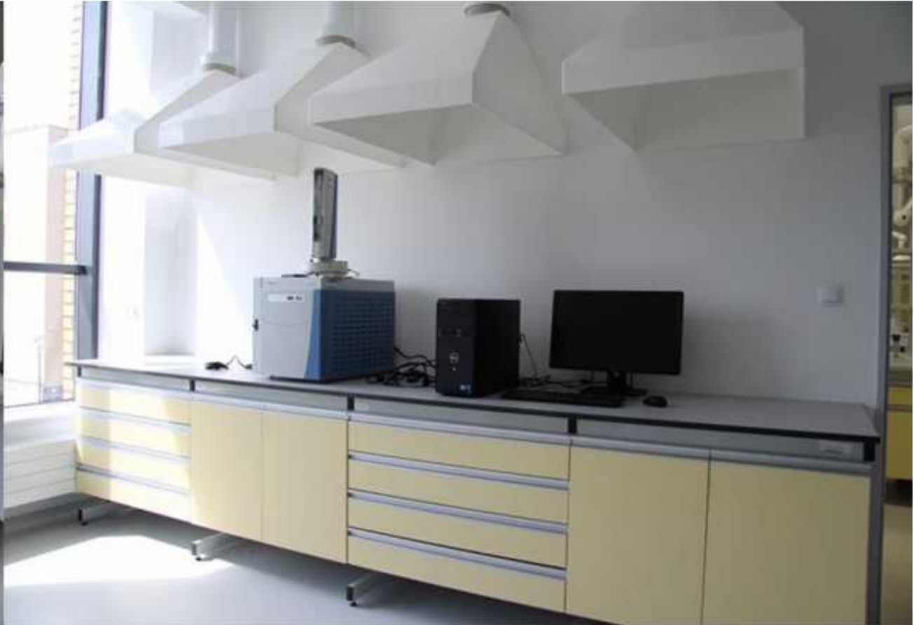
Thermo Scientific Trace 1300GC – Chromeleon 7.1 Chromatograf gazowy do oznaczania związków tlenowych posiada unikalny – błyskawiczny – system montażu dozowników i detektorów typu „Instant Connect” poprzez zintegrowanie modułów detektora z systemem zasilania gazami. Precyzyjna regulacja przepływów (z dokładnością 0,01kPa) zapewnia wysoką powtarzalność czasów retencji.
