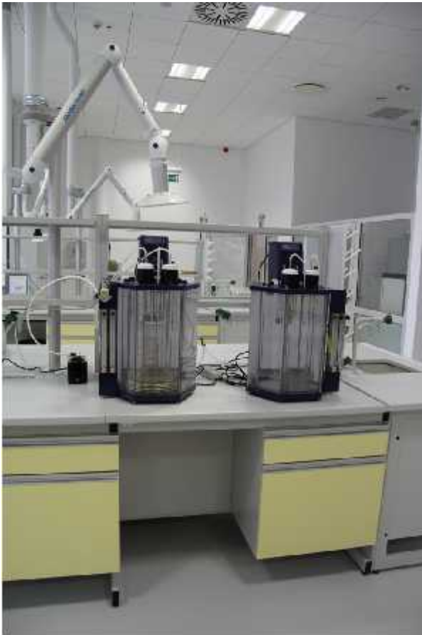
Stanhope-Seta model 14020-7 Zestaw do testu odporności na pienie.
